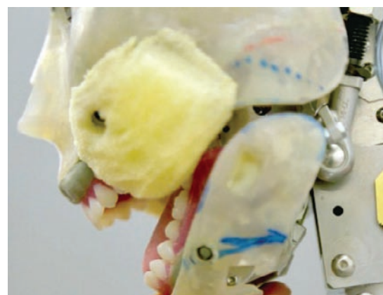
Gli androidi hanno anche espressioni facciali. Qui sopra il meccanismo facciale che permette di avere queste espressioni
